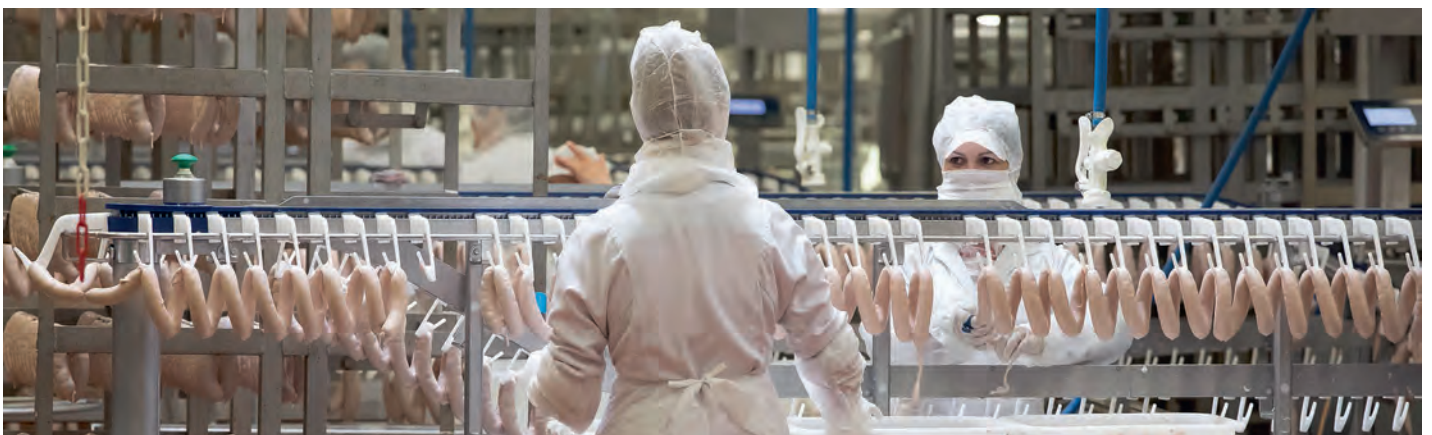
In der Naturdarm-Abfüllung werden tierische Därme eingesetzt. Abfüllen, aufhängen und ab zum Räuchern oder Brühen: An 14 Linien produzieren jeweils drei Beschäftigte Würstchen aus Fleisch, Gewürzen, Fett und Wasser. In Gläsern, Dosen oder Kunststoff werden sie verpackt, haltbar gemacht und etikettiert.
