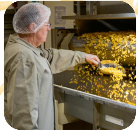
**Cornflakes-Produktion: Die Maiskörner werden vom Keimling befreit und zu Maisgritz gekocht. Der Maisgritz wird verfeinert, vorgetrocknet und zu Flocken gewalzt. Die noch weichen und flexiblen Cornflakes trocknen im Röster. Hier entsteht der leckere Crunch. Anschließend kühlen die Flake und werden luftdicht verpackt.**
