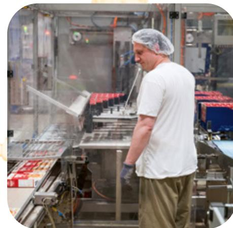
Hier entsteht Knuspermüsli: Zunächst werden Haferflocken, Nüsse, Samen, getrocknete Früchte sowie Honig oder Zucker gemischt und in die gewünschte Form gebracht. Dabei entstehen die typischen Cluster. Nach dem Backen wird das Müsli gekühlt und landet luftdicht in der Verpackung.
