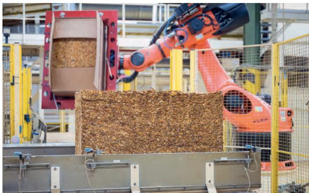
Der Roboter setzt die Rohtabak-Ballen auf das Band – er „entkleidet“ die Ballen, wie es korrekt heißt. Jeder Ballen wiegt 200 Kilogramm.
