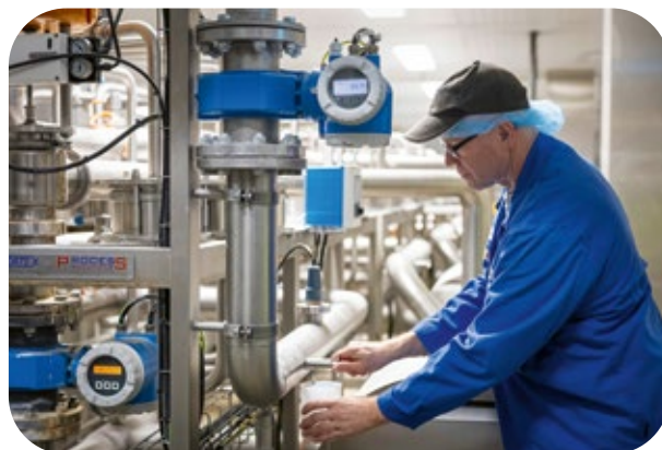
In der Anlage wird die Stärke unter Druck aus dem Fruchtwasser gewonnen. Schichtführer Herbert Talken zeigt die Stärkemilch, die anschließend getrocknet wird.
