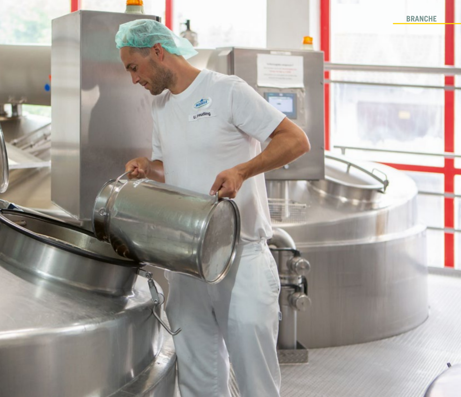
Käsereileiter Ulrich Freudling von Meggle Cheese am Käsefertiger: Hier wird noch einmal kontrolliert und eventuell weiteres Lab zur Kesselmilch gegeben.
