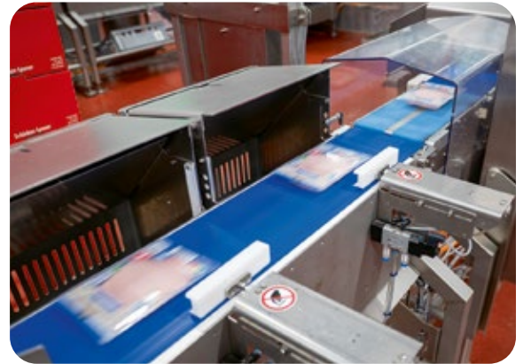
Der erste Arbeitsschritt: Fleischer Torsten Rogge kontrolliert das Fleisch und die anderen Zutaten mit dem Industriethermometer. Im Kutter schneiden scharfe Messer das Fleisch fein. Die fertig verschweißte Wurst läuft über Transportbänder in die Verpackung.
